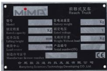
Поз. 3. Универсальная табличка грузоподъемности:
